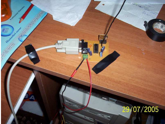
CKGMAR SILVER için kullanılan verici devrelerinden biri
